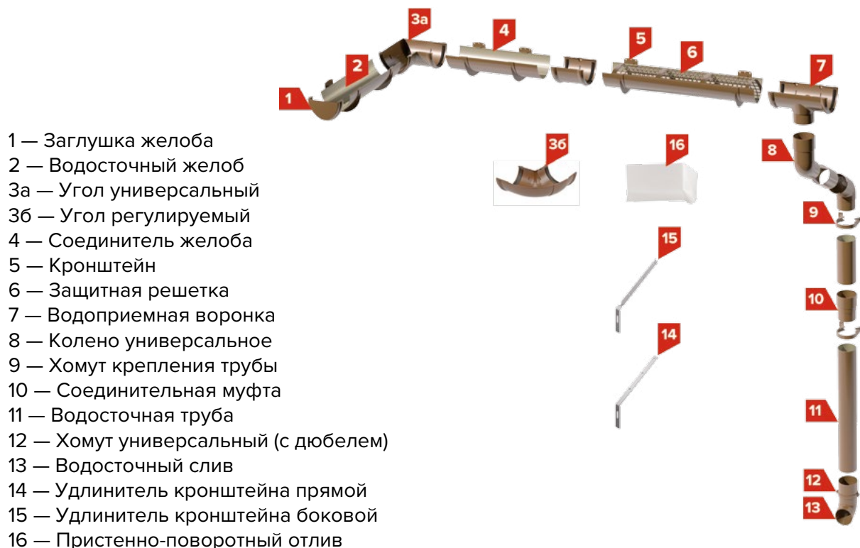
Рисунок Л. 1 — Элементы пластиковой водосточной системы ТЕХНОНИКОЛЬ
